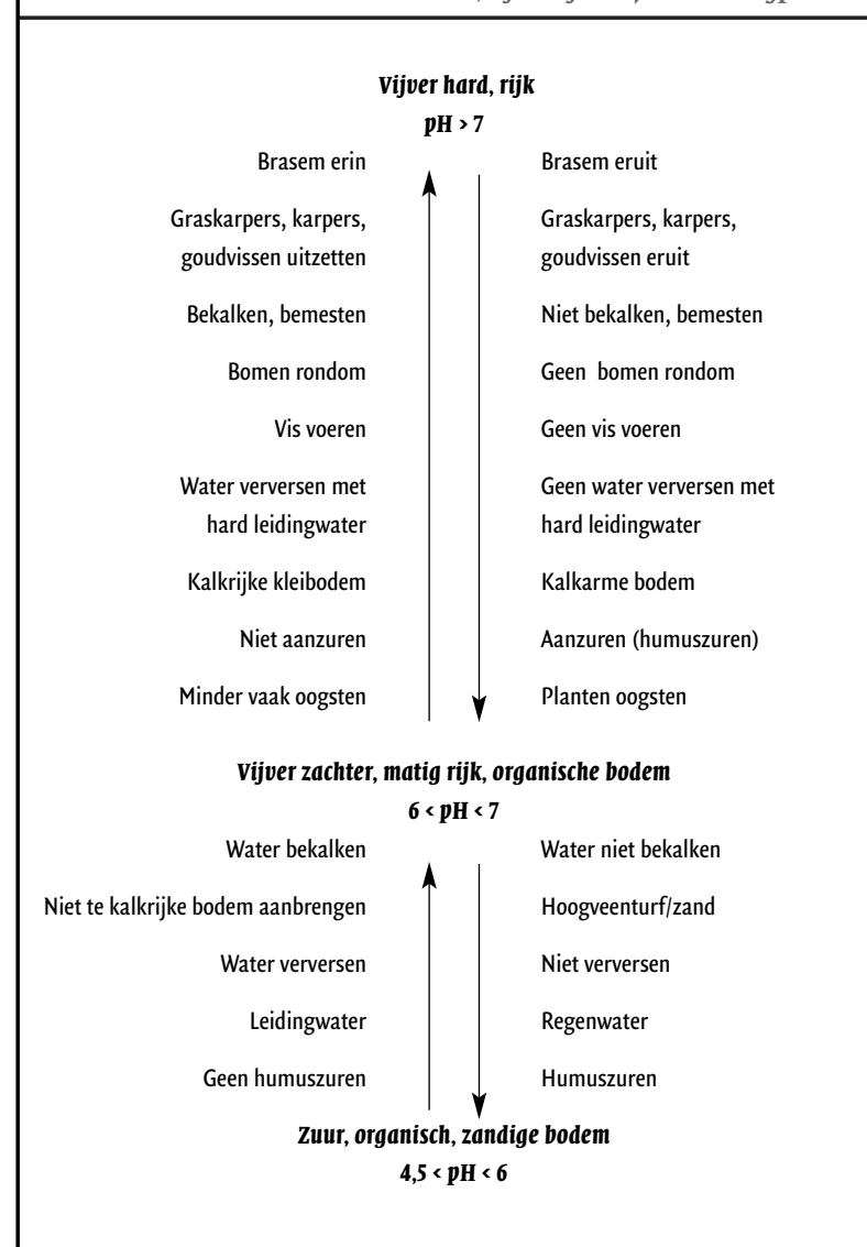
Schema 6 Hoe ontstaat een harde, rijke vijver of een zuur type?
